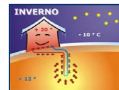
Sonda geotermica per il condizionamento naturale degli ambienti
