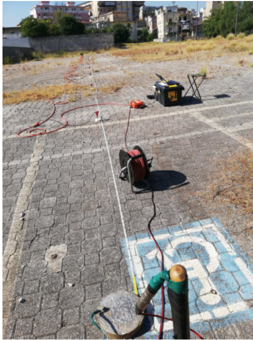
Foto 1 – Momenti di acquisizione sismica SS1 e MASW1
