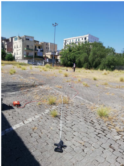
Foto 2 – Momenti di acquisizione sismica SS2 e MASW2
